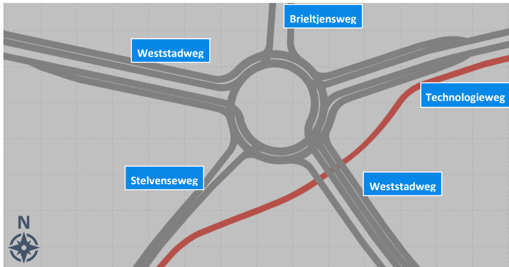
Figuur 4.4. Het definitieve ontwerp van de turborotonde als Vissimnetwerk.
