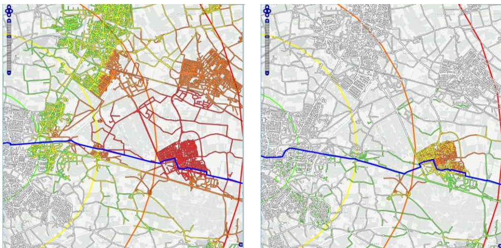
Afbeelding: Reistijdverschillen met de fiets ten opzichte van uitgangssituatie voor twee (van de zes) verschillende trajectalternatieven. De kleuren geven de reistijdwinst aan vanuit Breda Centrum – geel betekent dat deze plek met de nieuwe route 1 minuut sneller bereikt kan worden, rood betekent dat de plek met de fiets meer dan 5 minuten sneller bereikt kan worden door de nieuwe snelfietsroute.
